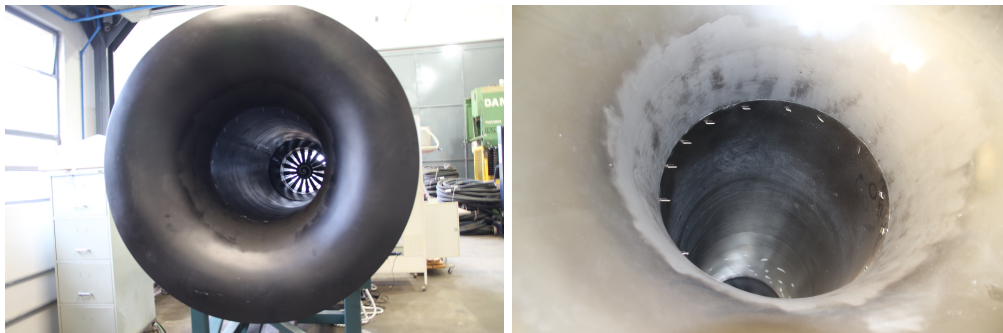
Figura 3.7: Bocal (a) e detalhe do amaciamento entre as peças.
