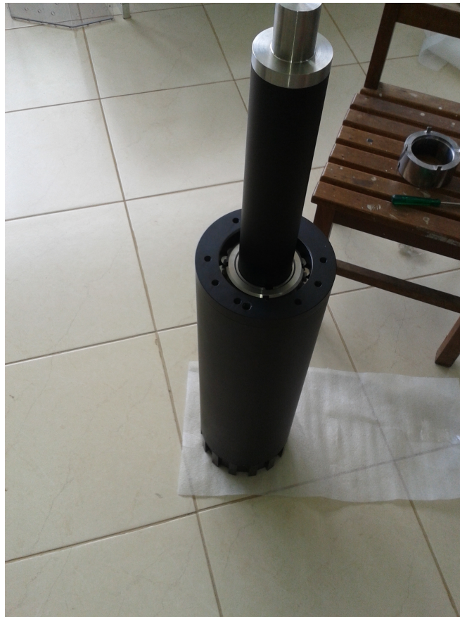
Figura 3.3: Foto do conjunto eixo mancal que faz a transmissão da potência para o rotor.
