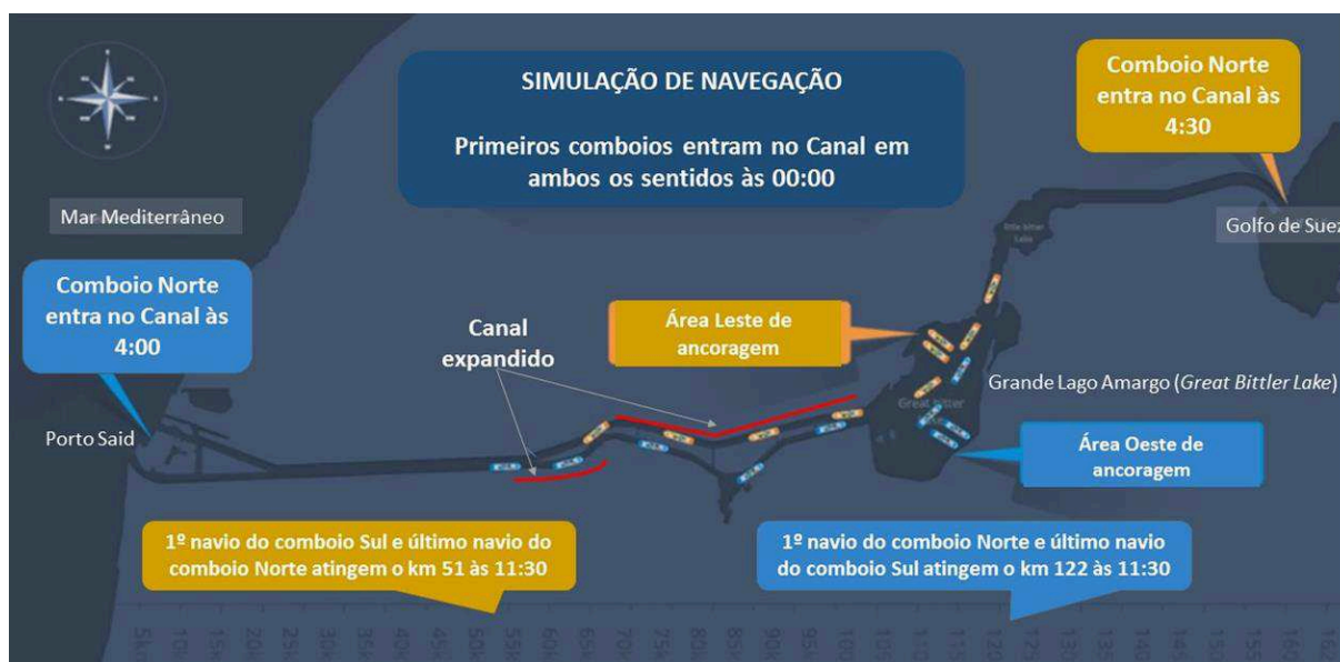
Figura 4 - Componentes do Canal de Suez
