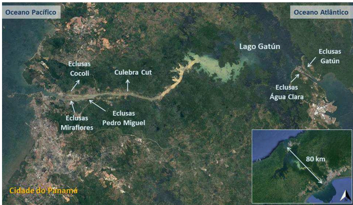
Figura 7 - Componentes do Canal do Panamá
