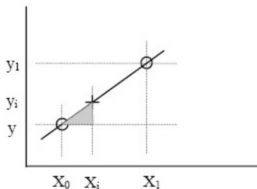
Figura 4 - Interpolação linear entre dois pontos
