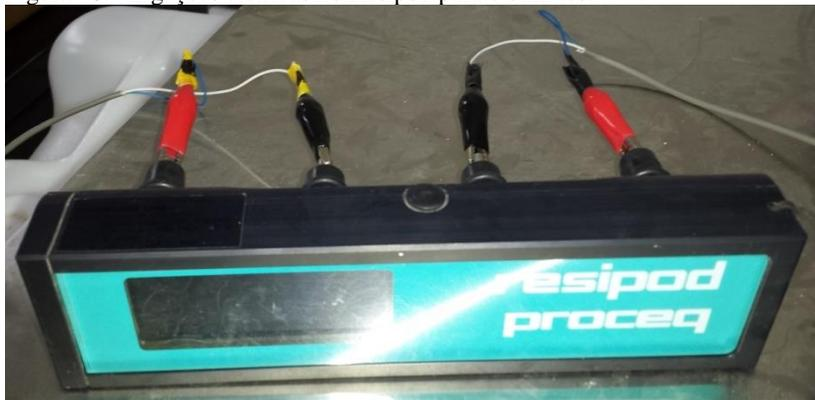
Figura 41 – Realização do bulk test.
