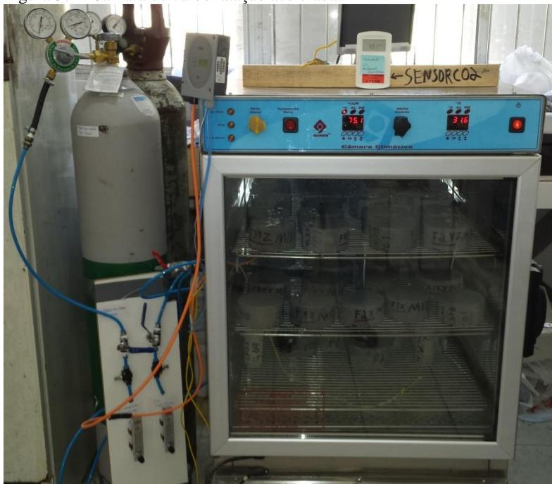
Figura 38 – Esquema da instalação da câmara de carbonatação acelerada.
