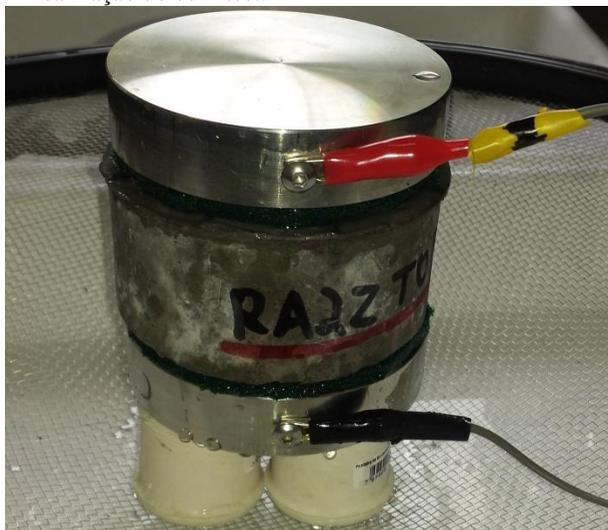
Para isolar o aparato da superfície foram utilizados pedaços de borracha não condutores. As esponjas utilizadas foram antes de cada medida encharcadas em água, a soma das duas leituras de resistividade elétrica das esponjas eram em média 5,5 kΩcm.
