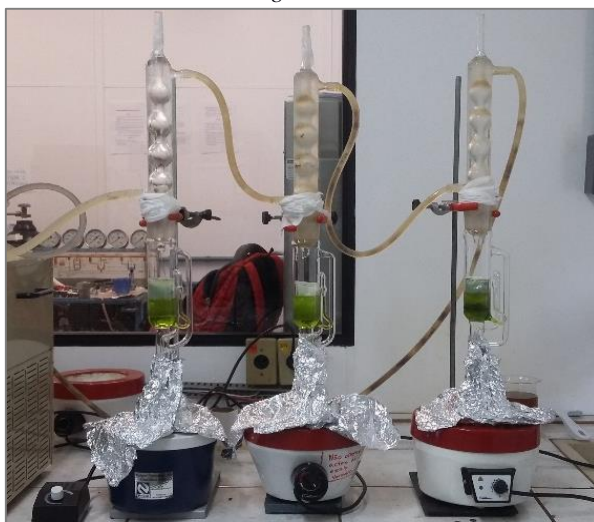
Figura 11 – Aparato utilizado para a extração com solvente orgânico via Soxhlet.
