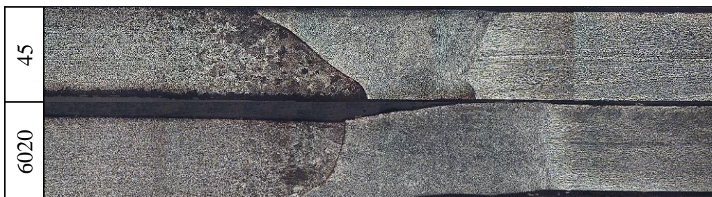
Figura 35 - Variação na extensão da ZTA em função da introdução de ultrassom no processo de soldagem.
