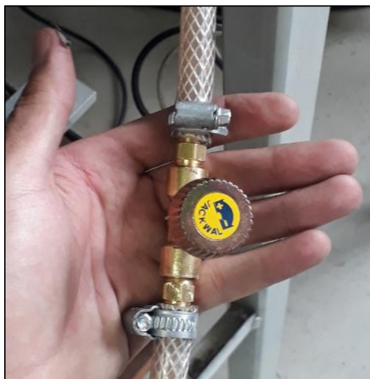
Figura 12 – Válvula utilizada para o controle da vazão do gás de proteção.
