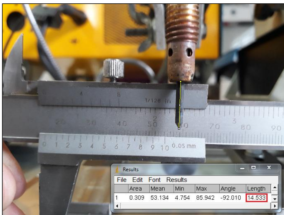
Figura 15 – Utilização do software ImageJ para obter o comprimento do eletrodo percorrido por corrente.
