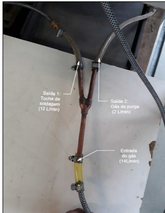
Figura 11 – Divisor de fluxo do gás de proteção.
