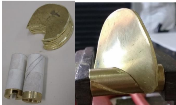
Figura 19 - Material cortado (esquerda) e proceso de conformação (direita).
