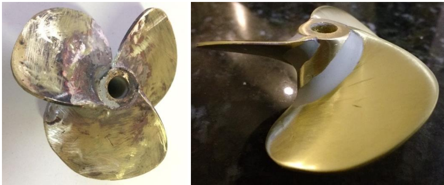
Figura 20 - Processo de brasagem (esquerda) e suavização de cantos vivos (direita).
