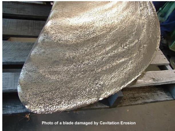
Figura 13 - Erosão da superfície das pás do hélice.
