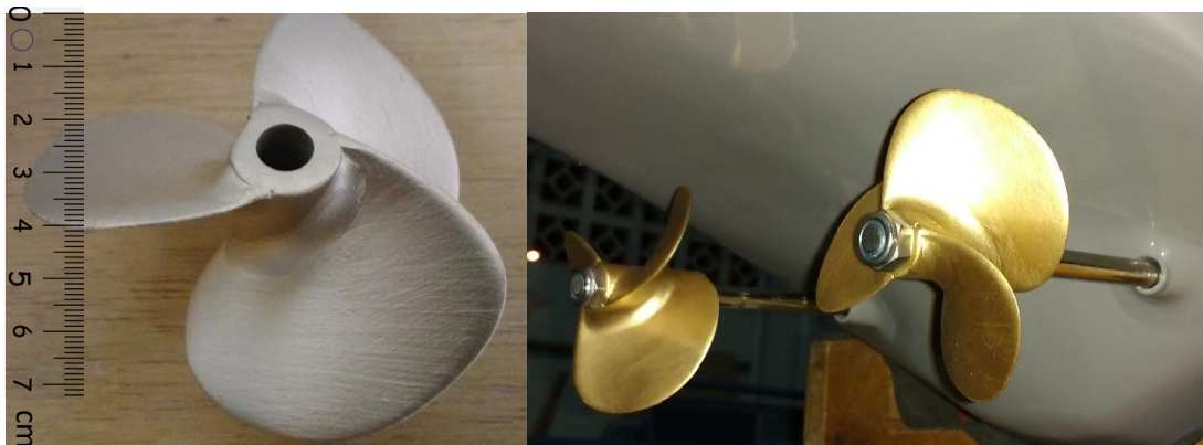
Figura 21 - Hélices finalizadas (esquerda) e montagem na embarcação (direita).
