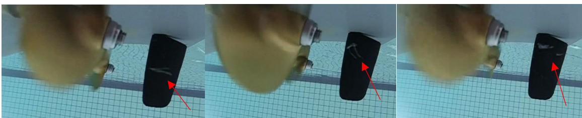
Figura 28 - Ocorrência de cavitação no Hélice 80mm.
