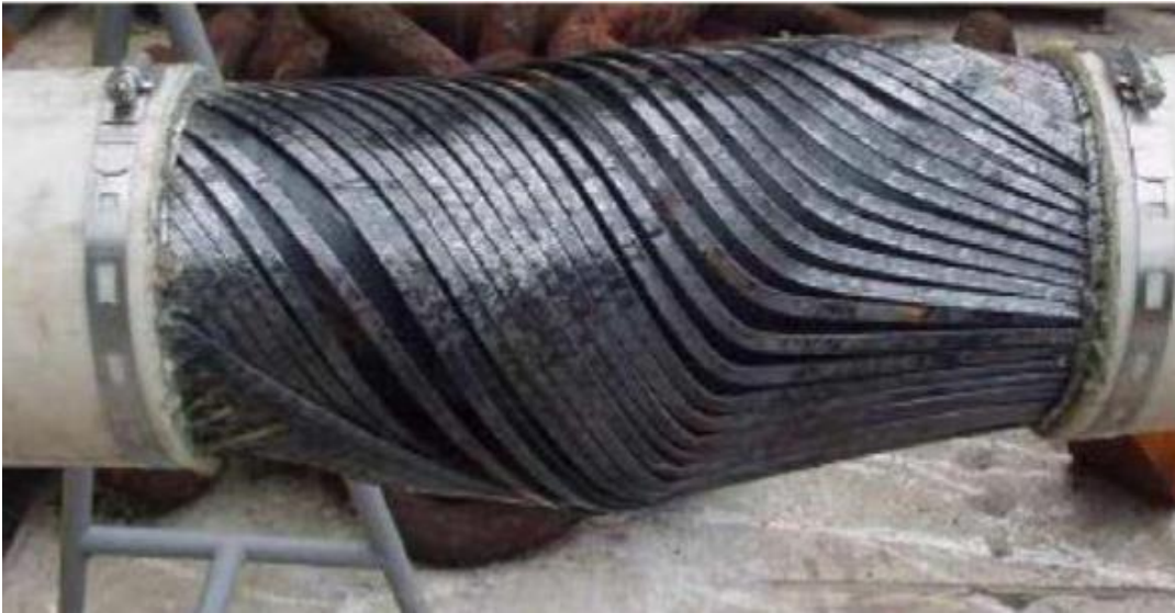
Figura 2 - Tubo flexível após ter falhado por instabilidade lateral
