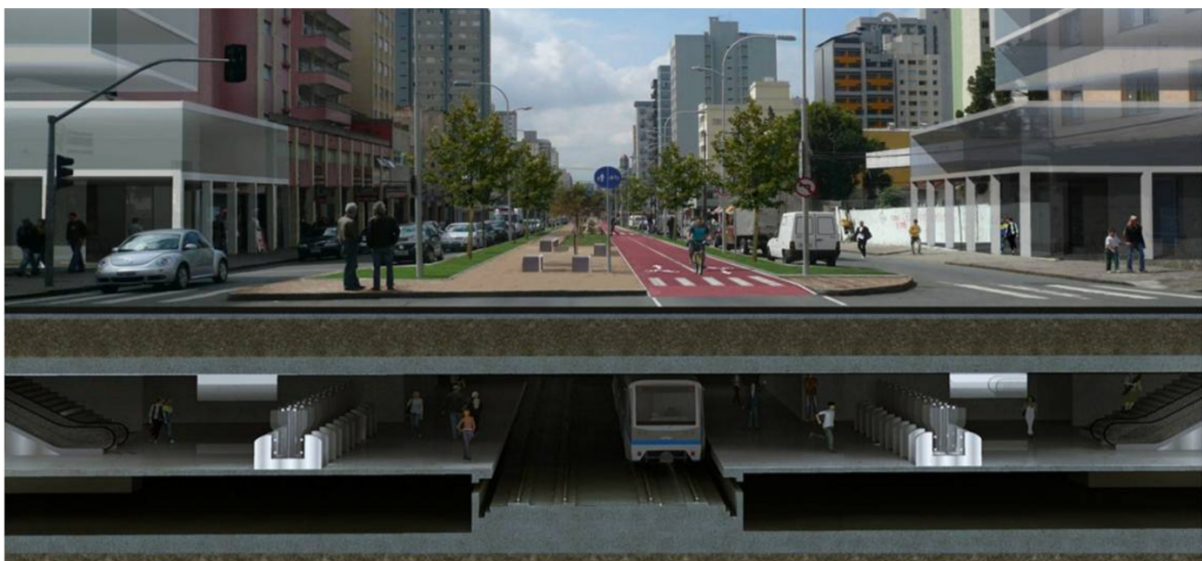
Figura 11 – Seção do projeto do metrô subterrâneo
