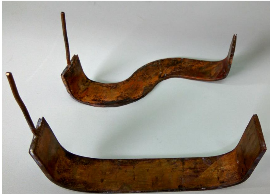
Figura 18 – Tubos de calor 1, abaixo, e 2, acima, após adaptação.
