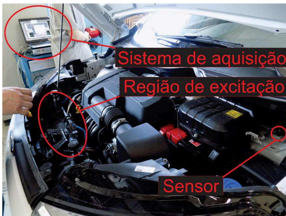
Figura 28 - Aquisição da aceleração para cálculo da razão de amortecimento.
