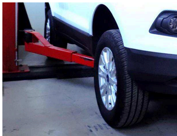
Figura 27 - Eixo dianteiro na eminência de tocar o solo para a obtenção da razão de amortecimento traseira.
