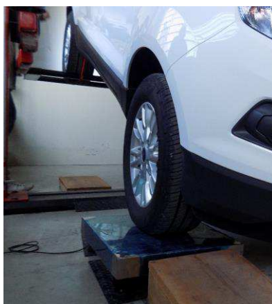
Figura 22 - Elevação do veículo para o cálculo do CG.
