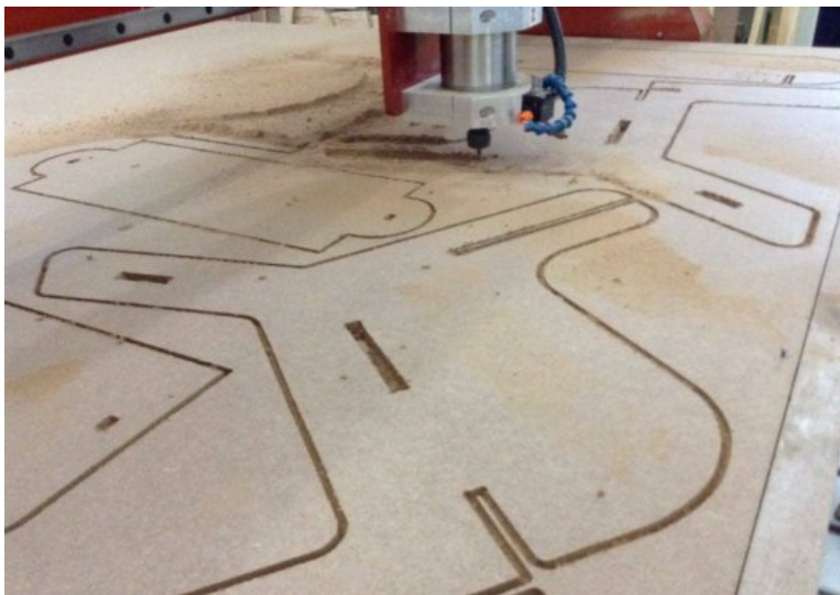
Figura 22 - O material sendo cortado no formato do arquivo digital
