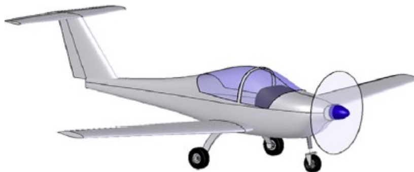
Figura 34 - Configuração de trem de pouso triciclo utilizado no projeto da aeronave de pulverização agrícola
