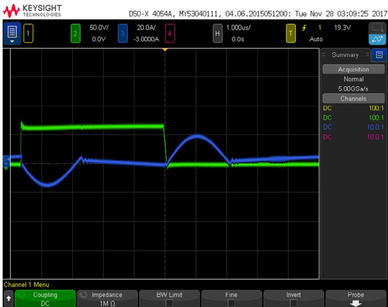
Figura 4.20 – Comutação suave dos diodos  $D_o$  e  $D_1$ . (1)  $v_{D1}$ , (3)  $v_{D2}$ , (2)  $i_2$ .
