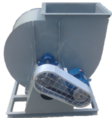
Figura 16 – Exaustor do sistema de aquecimento com motor de indução trifásico 3 cv.
