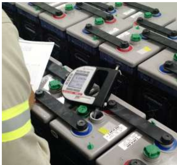
Figura 39. Densímetro utilizado para medir densidade e temperatura das células.
