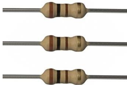
Figura 7: Resistores. Fonte: Site google, 2017.
