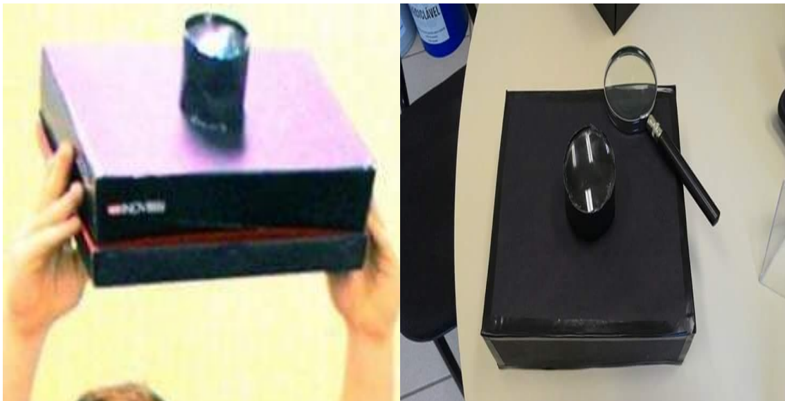
Figura 18: Câmara escura de orifício. Fonte: Arquivo da autora.
