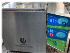
Figura 13 – Equipamento utilizado no processo de extração sólido-líquido assistida por ultrassom
