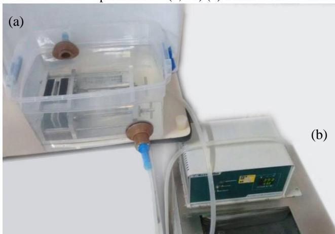
As soluções de lipase foram submetidas ao campo acondicionadas em pipetas de *Pasteur*, devidamente posicionadas no centro do campo. As amostras não submetidas à indução magnética foram denominadas de amostras controle.
