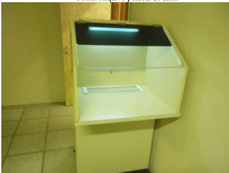
Figura 11 - Mesa de sucção para higienização das obras (mesa higienizadora) Fonte: Arquivo pessoal do autor
