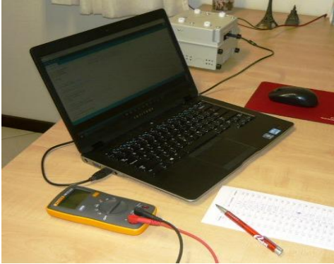
Figura 19 - Medição da corrente elétrica consumida pela luminária.
