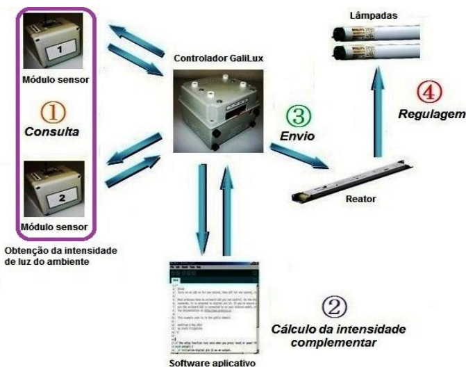
Figura 9 - Esquema de funcionamento do protótipo desenvolvido.
