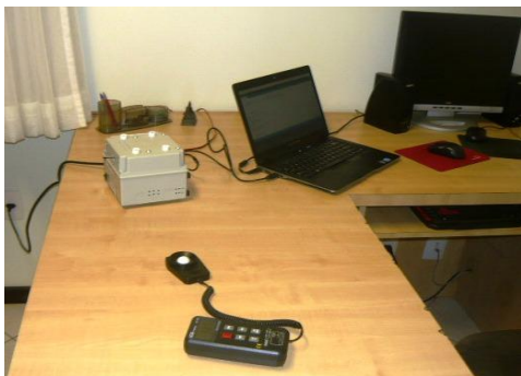
Figura 18 - Medição da quantidade de lux do ambiente de monitoramento.
