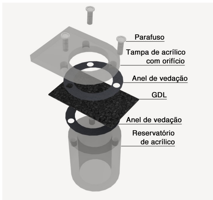
Figura 13. Esquema da célula de polimetilmetacrilato utilizado para a caracterização da célula híbrida a biocombustível. (para melhor visualização o esquema mostra a célula na posição invertida)
