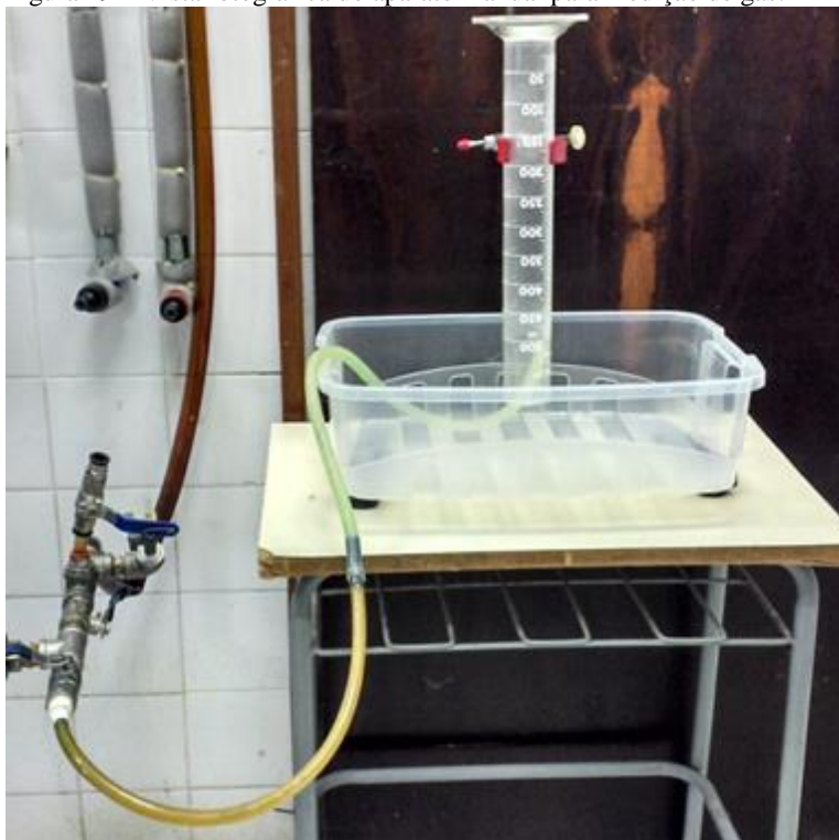
Figura 29 – Vista fotográfica do aparato manual para medição de gás.
