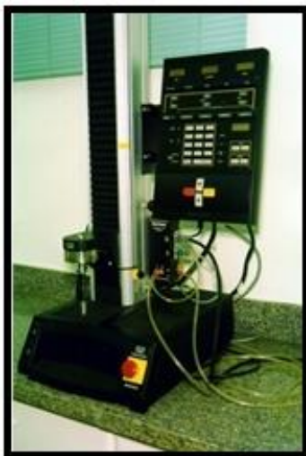
Figura 16 – Máquina de ensaios mecânicos Instron (Instron 4444, Instron Inc., Canton, EUA).
