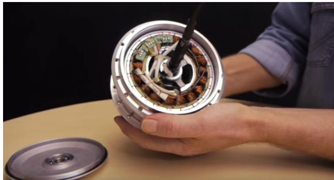
Figura 4 - Motor de eixo 36 V 350 W.
