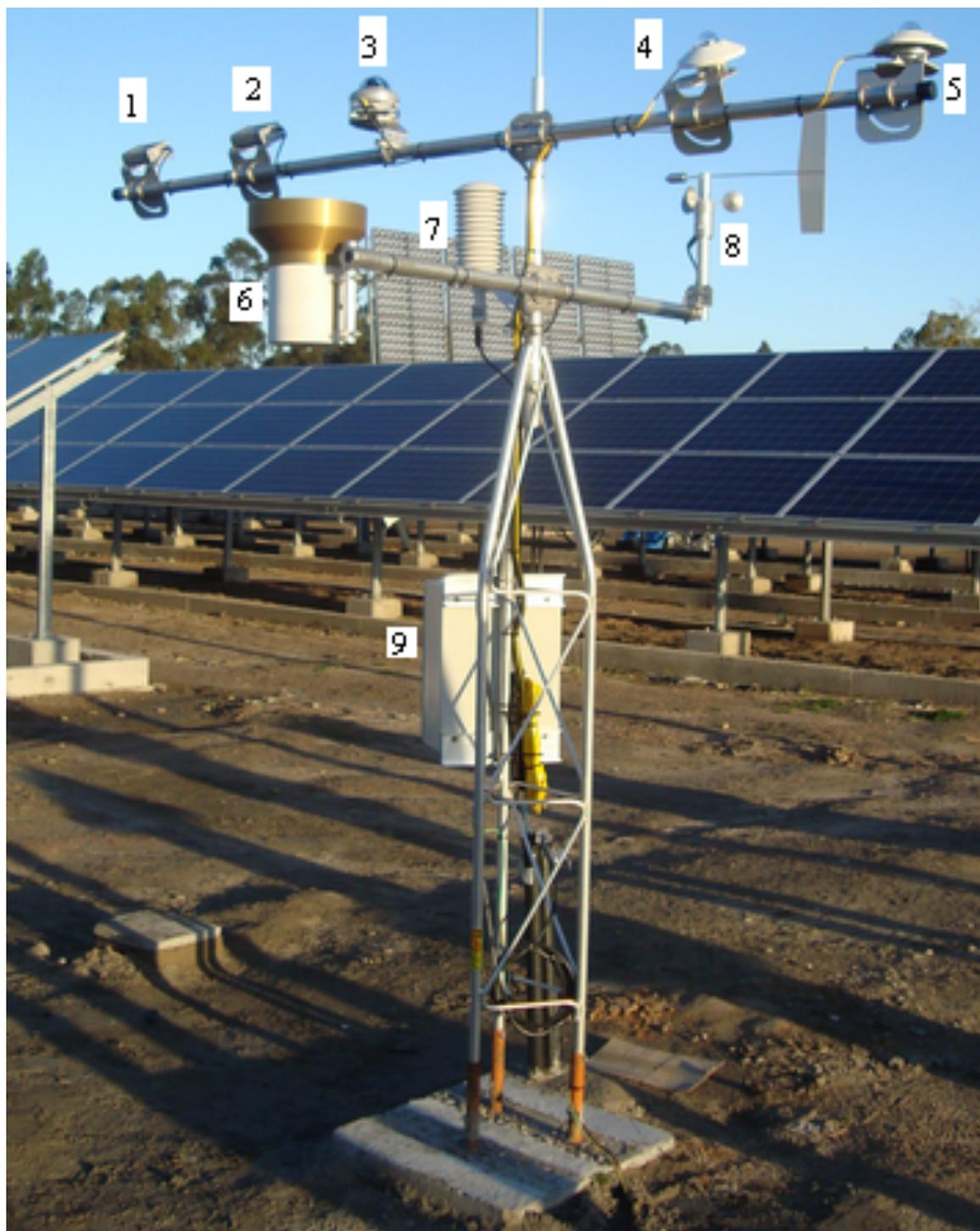
Figura 18: Estação Solarimétrica.
