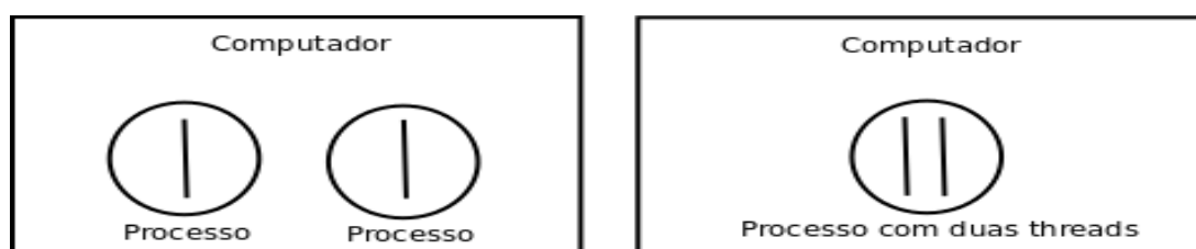
Figura 11: Exemplo de processo monothread e multithread.
