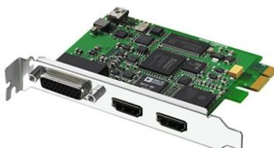
Figura 29: Placa de transmissão *Intensity Pro*, fabricado por *Blackmagic Designs*
