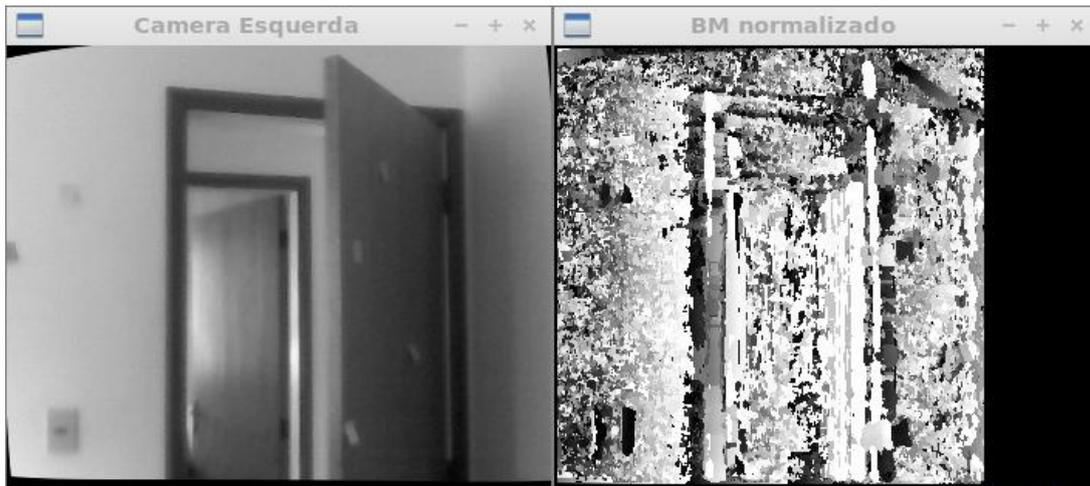
Figura 11 Resultado de um block matching usando variáveis mal escolhidas.
