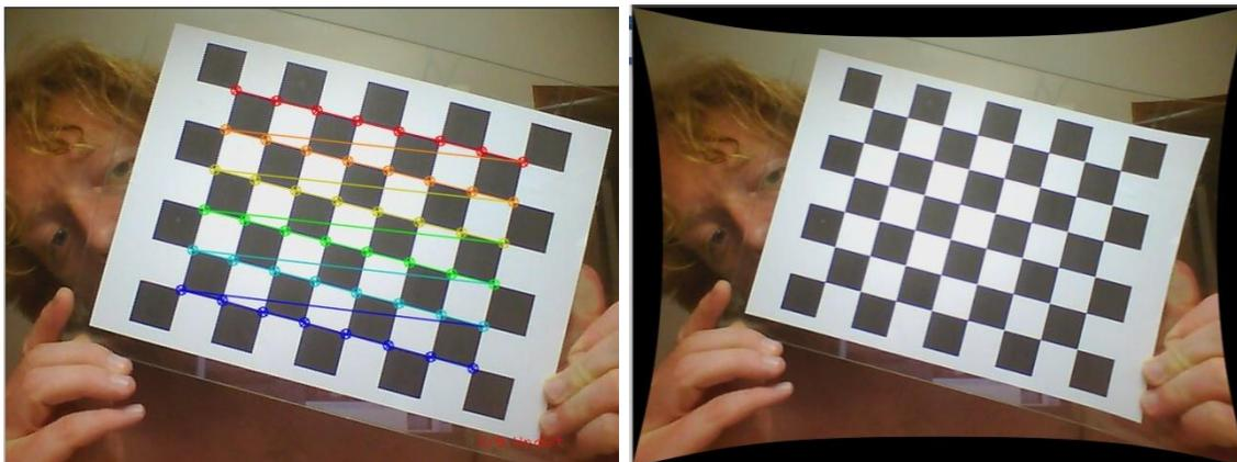
*Figura 1 À Esquerda (a): Padrão de tabuleiro de xadrez com os cantos identificados pelo algoritmo. À Direita (b): a mesma imagem, porém corrigida utilizando os parâmetros de calibração aferidos com auxílio dos pontos identificados a esquerda.*
