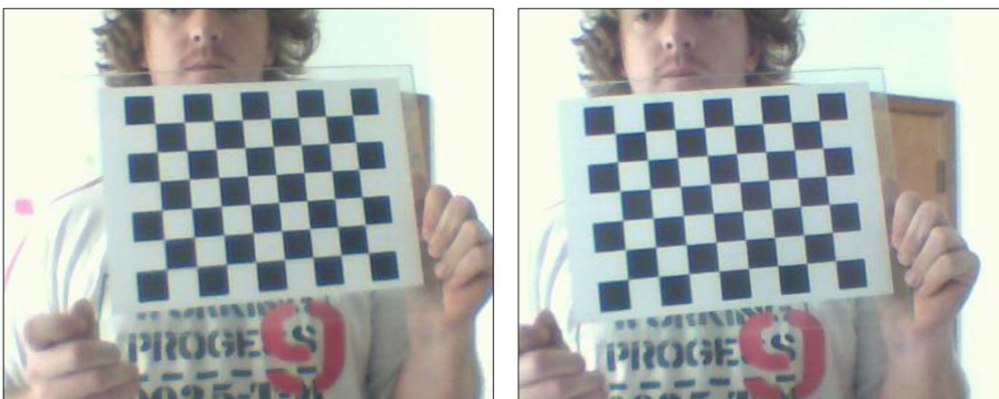
*Figura 3 Par de imagens adquiridas pelas duas câmeras simultaneamente do tabuleiro de Xadrez para efetuar a calibração estéreo.*
