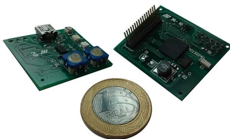
Figura 1. EPOSMoteII ao lado de uma moeda de R\$1.
