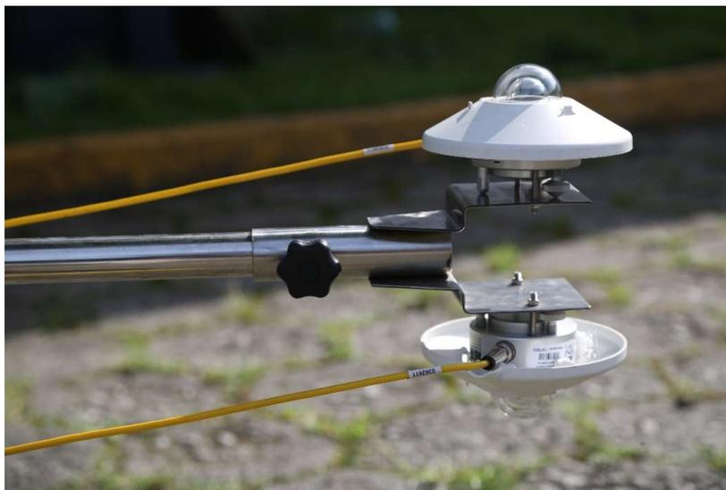
Figura 3.4– Detalhe de montagem dos dois piranômetros.
