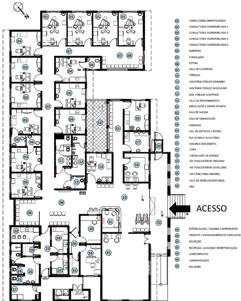
Figura 23 - Planta baixa do pavimento Térreo
