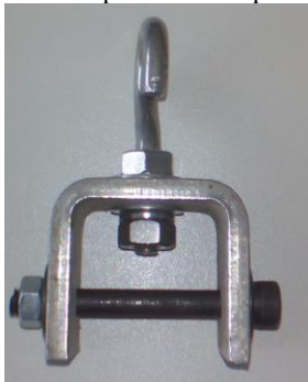
Figura 27 – Acessório com parafuso liso para fixação da polia.
