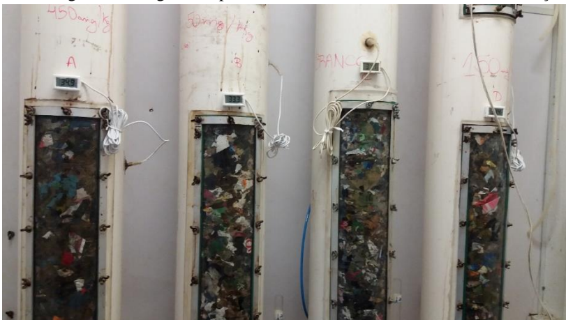
Figura 12: Imagem dos pilotos com detalhes dos termômetros e marcação.
