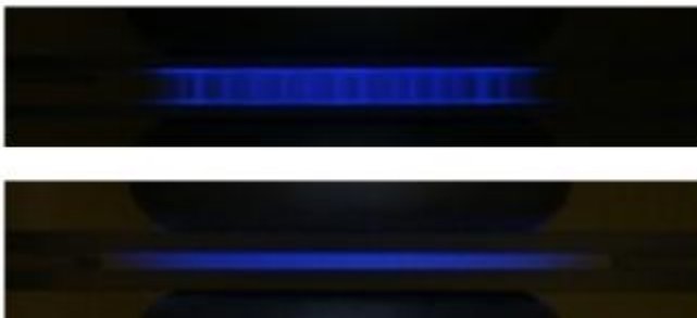
Figura 3. Aspecto dos dois modos de regime obtidos em plasma frio-DBD. (A) regime filamentar e (B) regime difuso
