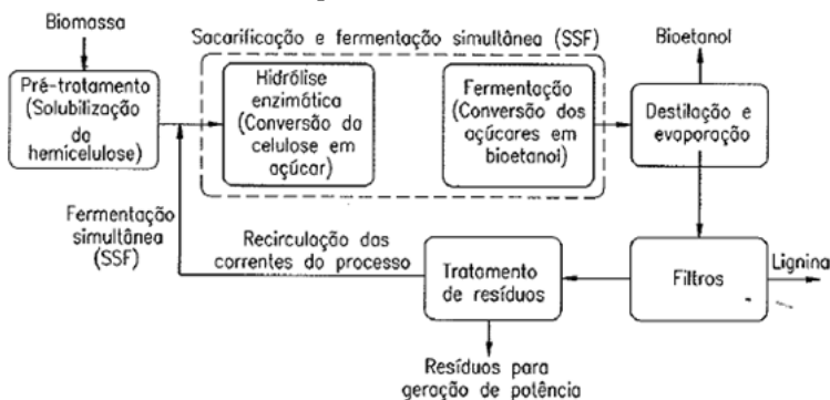
Figura 12: Diagrama de fluxo de processo de conversão de biomassa em etanol utilizando-se dentre várias etapas, a hidrólise enzimática.
