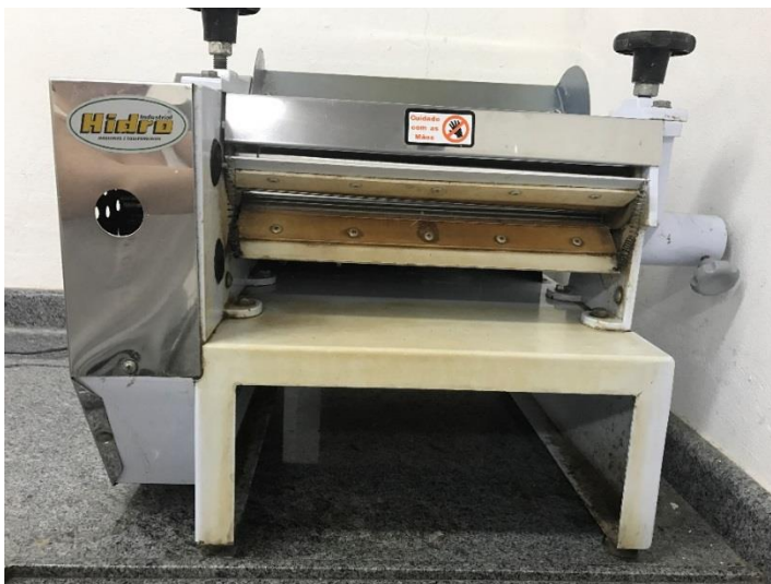
Figura 18: Fotografia da prensa de cilindro para massas Hidro Industrial HB-350.
