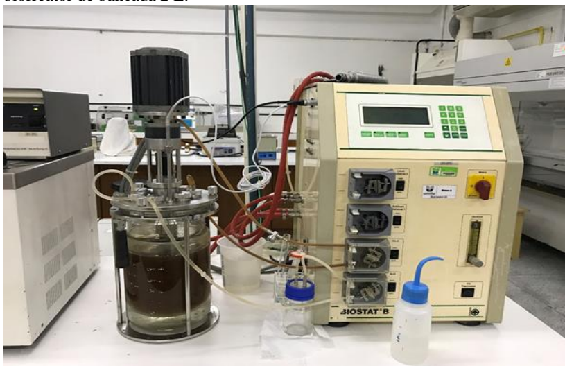
Figura 23: Conjunto de equipamentos para realização dos experimentos em biorreator de bancada 2 L.
