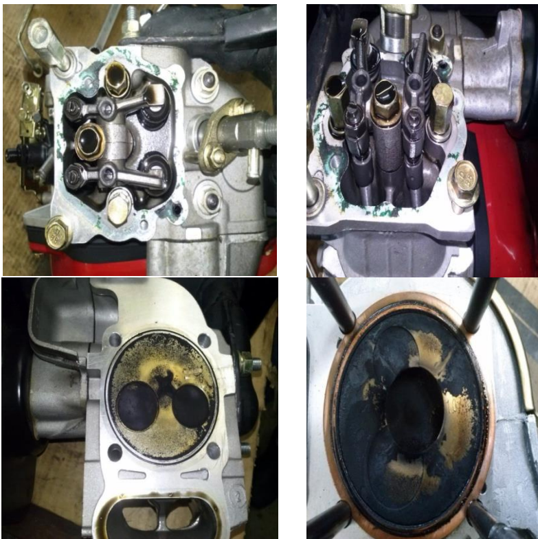
Figura 12 - Limpeza e reparos realizados no motor utilizado no estudo (a) vista superior: tampa do cabeçote e válvulas (b) vista lateral: tampa do cabeçote e válvulas (c) cabeçote carbonizado (d) topo do pistão carbonizado.
