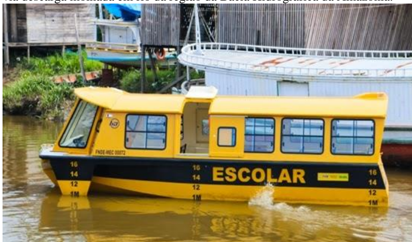
Figura 5 – Demonstrativo da saída dos gases do escapamento do motor diesel via descarga molhada em rio da região da Bacia Hidrográfica da Amazônia.
