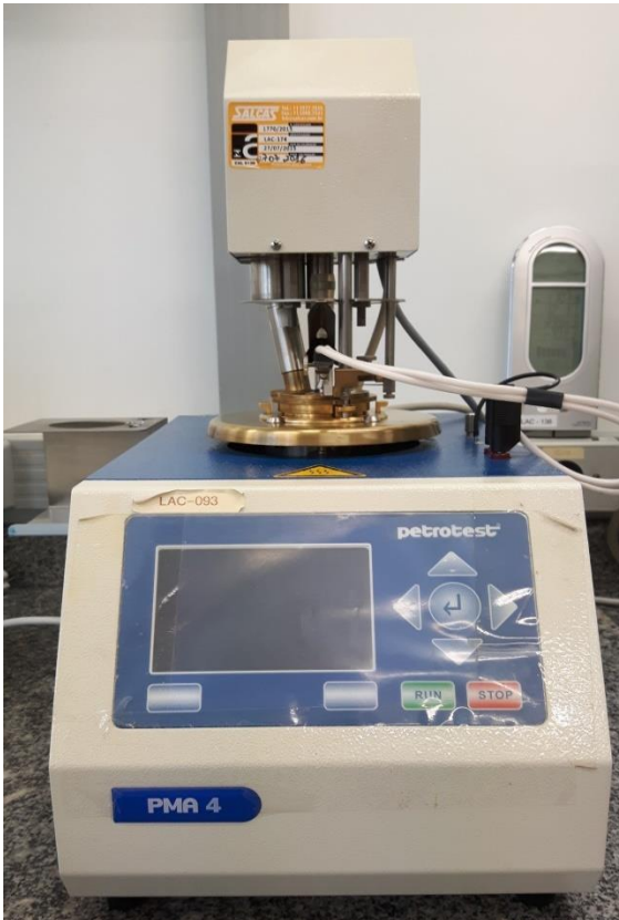
Figura 17 – Aparato experimental para determinação do ponto de fulgor.
