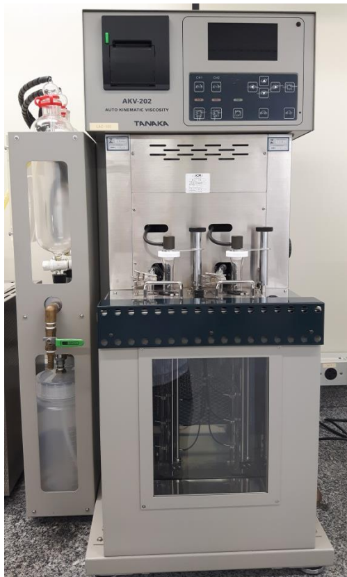
Figura 16 – Aparato experimental para determinação da viscosidade cinemática.
