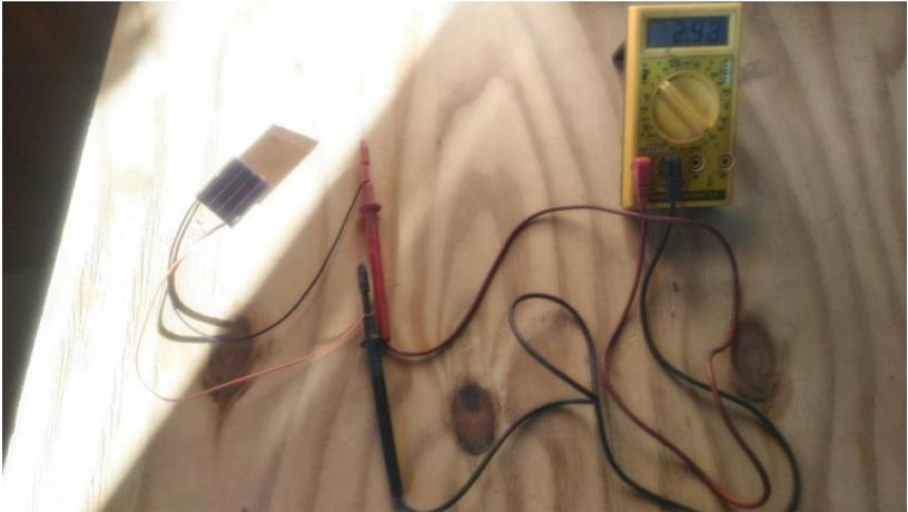
Foto 7 – Montagem experimental com a fotocélula exposta ao sol
