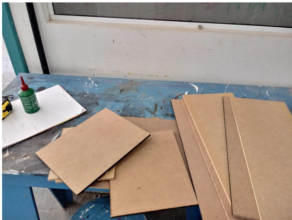
Figura 44 - Madeiras cortadas para dar início a montagem da lixeira
