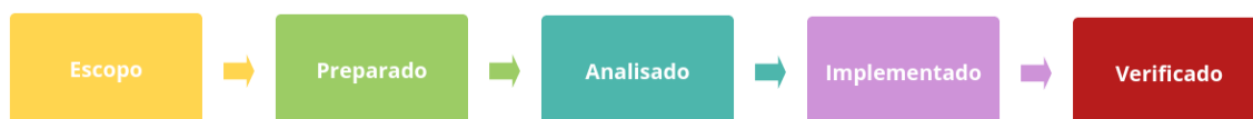
Figura 8 - O ciclo de vida de uma fatia de caso de uso Fonte: HAUCK, 2016 - Adaptado
