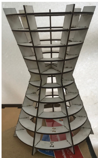
Figura 3 - Pé de mesa cortado em pvc expandido.
