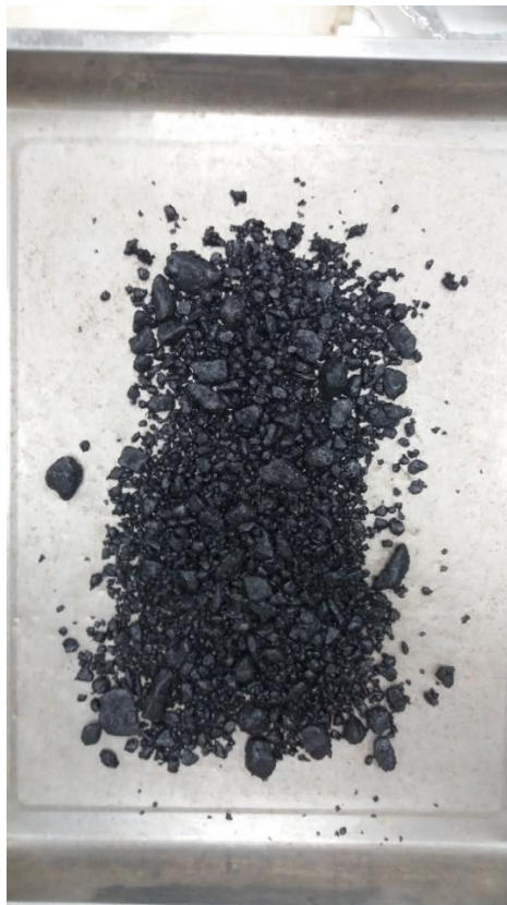
Figura 28 – Segregação da mistura.
