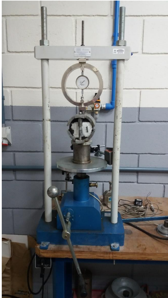
Figura 31 – Prensa Marshall com corpo de prova acomodado para rompimento.
