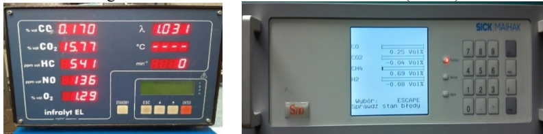
Figura 19 - Analisador de gases de exaustão SAXON INFRALYT EL (esquerda) e analisador de gases combustíveis SICK MAIHAK S710 (direita).
