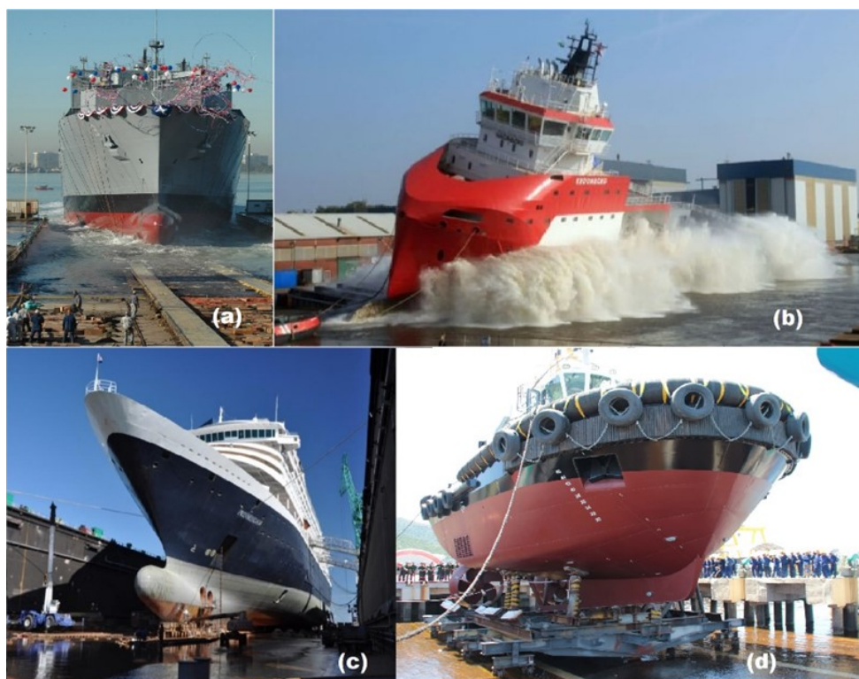
Figura 1 - Lançamentos: Gravitacional Longitudinal de Popa (a), Gravitacional Lateral (b), Flutuante (c), Mecânico (d).
