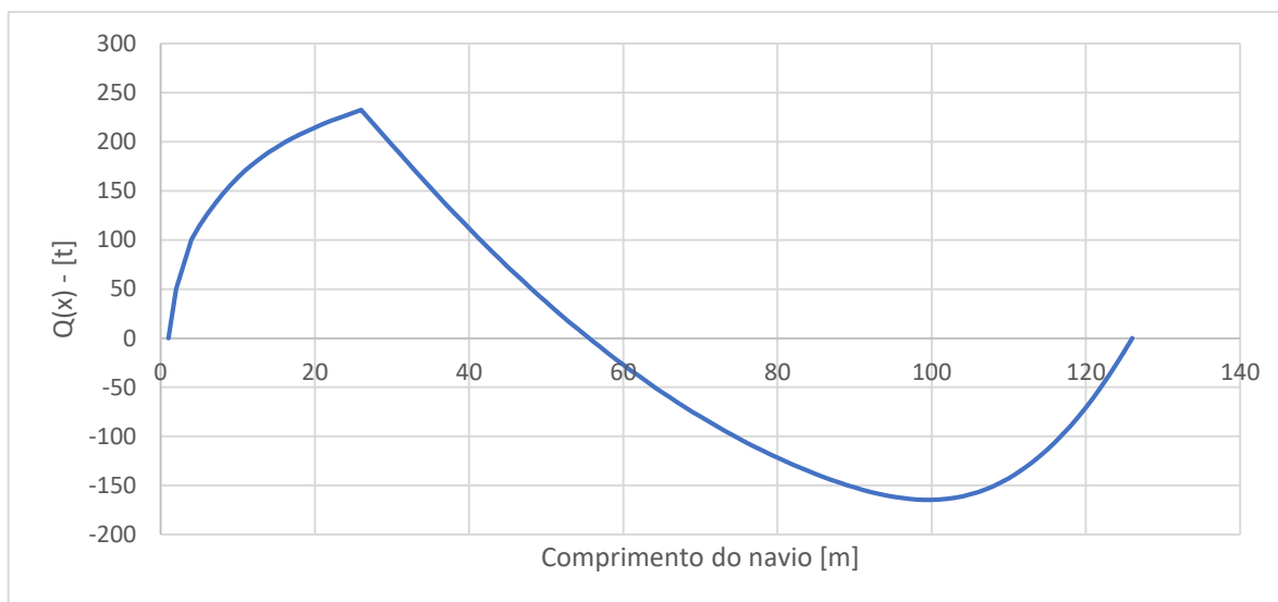
Figura 8 – Diagrama de força cortante para condição de equilíbrio.
