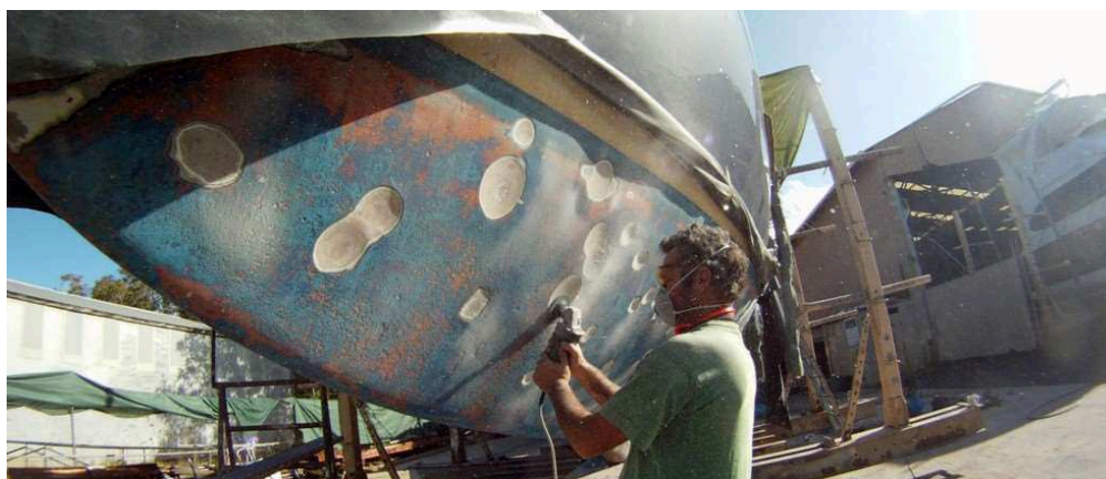
Figura 11 – Reparos em bolhas no casco por efeito da osmose
