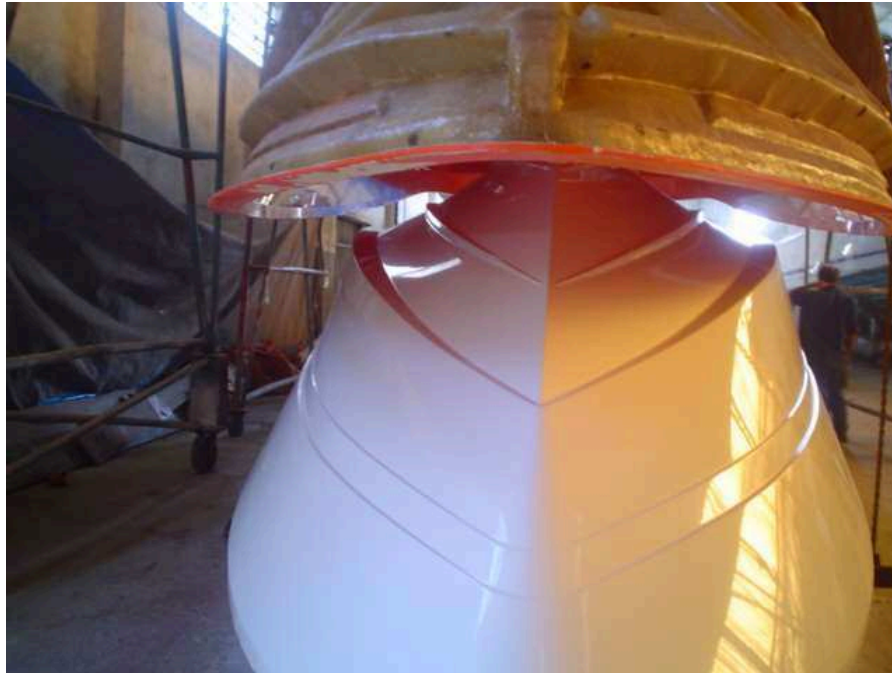
Figura 2 - Exemplo de molde em estaleiro náutico
