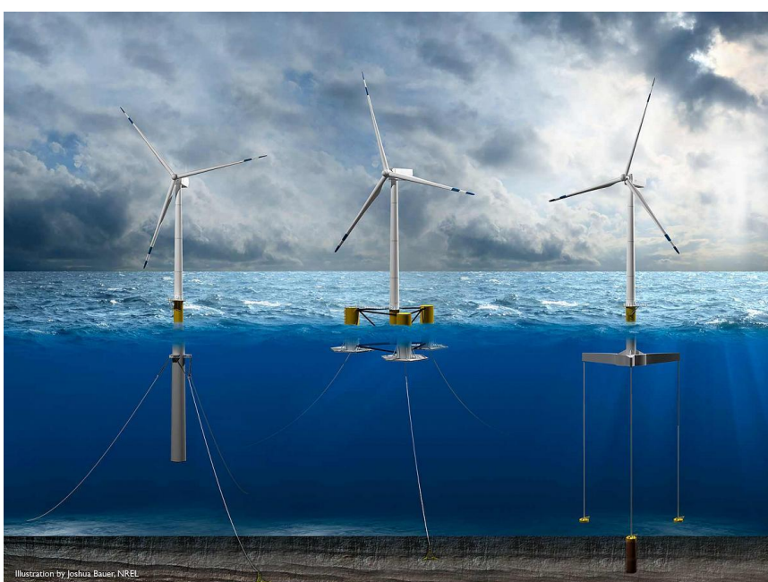
Figura 12 – Conceitos de Fundação para Turbina Eólicas Offshore .
