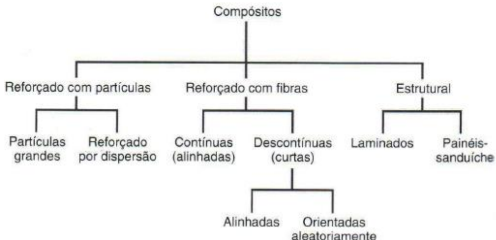
Figura 2 - Esquema de classificação dos três principais grupos de materiais compósitos .
