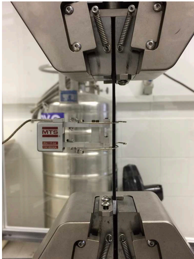
Figura 9 – Corpo de prova montado na máquina para ensaio de tração.
