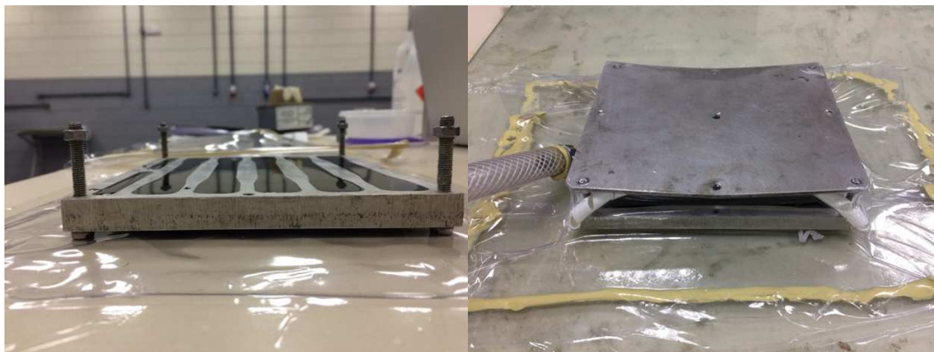
Figura 7 – Fotografias do molde e da bolsa de vácuo sobre este.
