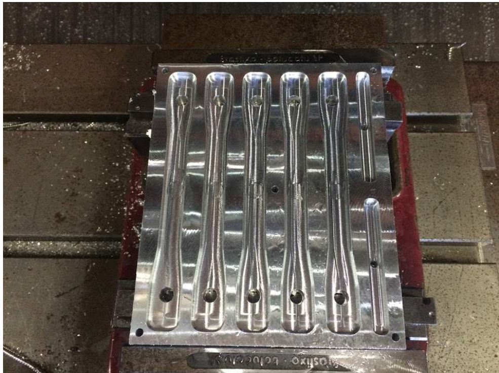
Figura 3 – Molde após o processo de usinagem.
