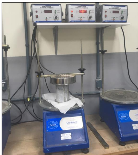
Figura 13 – Adaptação do adensamento através do processo de vibração.
