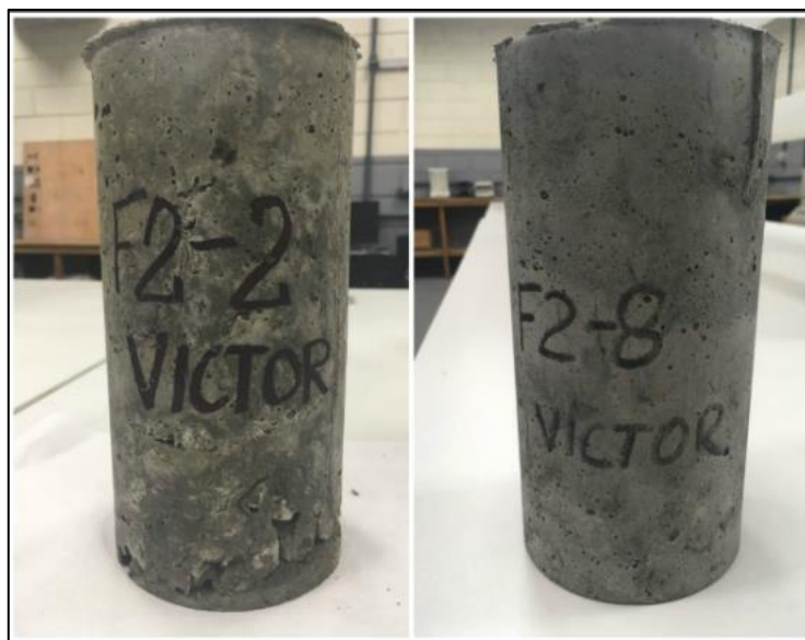
Figura 23 – Formato dos CP's para a Formulação F2 após implementação do processo de adensamento mecânico.
