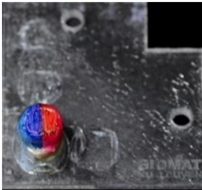
Figura 6: Espécime restaurado e aderido à placa de PMMA para corte e obtenção de mini-espécimes. Diferentes cores (azul e vermelho) correspondem a grupos experimentais distintos.
